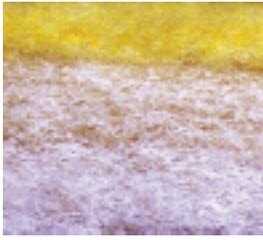
Photo réelle de la coupe transversale d'un filtre à 2 plis
