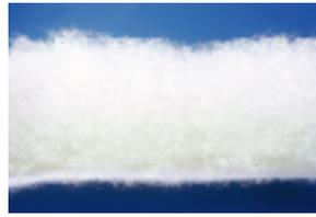
Photo réelle de la coupe transversale d'un filtre à 3 plis
